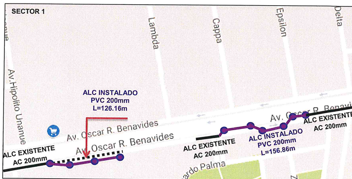
Imagen 8. Red Secundaria de Alcantarillado PVC Ø200mm Operativo
