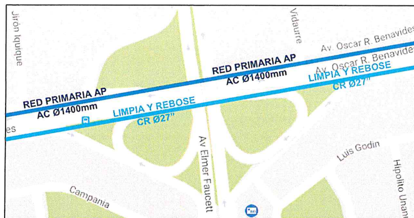
Imagen 2. Ubicación inicial de redes de Agua Potable y de Limpia y Rebose en la Estación E-05 Carmen de la Legua
